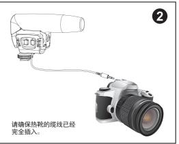
防震架底采用标准的相机热靴插座设计,可以轻松地将话筒安装固定于相机的热靴座上。这是为了减少操作和机械噪音传给麦克风,底部设有一个3/8英寸的螺纹插座,可以安装在三脚架上和话筒支架上。有些过时型号的或低价的相机可能会产生很大的机械噪音,VN-6完全可以避免这些缺陷。集成的高通滤波器可以有能力去减少这些低频率的噪音。
