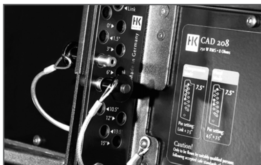
Abb. 20: Beispiel Fixed Mode bei 4,5^\circ
