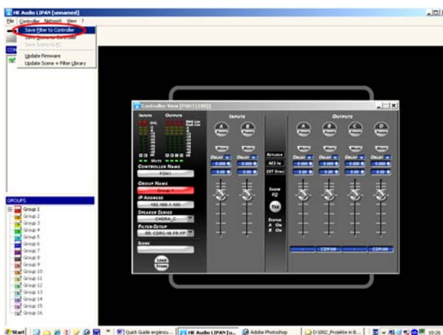
Abb. 28: FirNet™ – Öffnen des Dialogfeldes zum Aufspielen von Einzelfiltern
