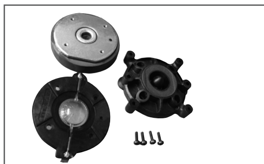
Abb. 38: Demontierte Schwingspule des CAD 208 Hochtontreibers
