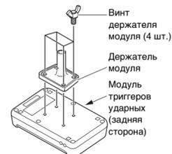
2. Вставьте держатель модуля в зажим держателя и затяните зажимной болт для фиксации в нужном положении.
