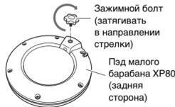
2. Прикрепите пэд малого барабана XR80 к стержню, а затем зафиксируйте его, затянув зажимной болт.
