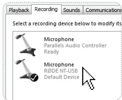
Рис. 10 - Выбор NT-USB в качестве входного устройства
