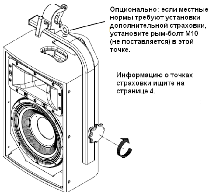
Рис 5а. Затягивание VSA-1 на колонке серии PX
