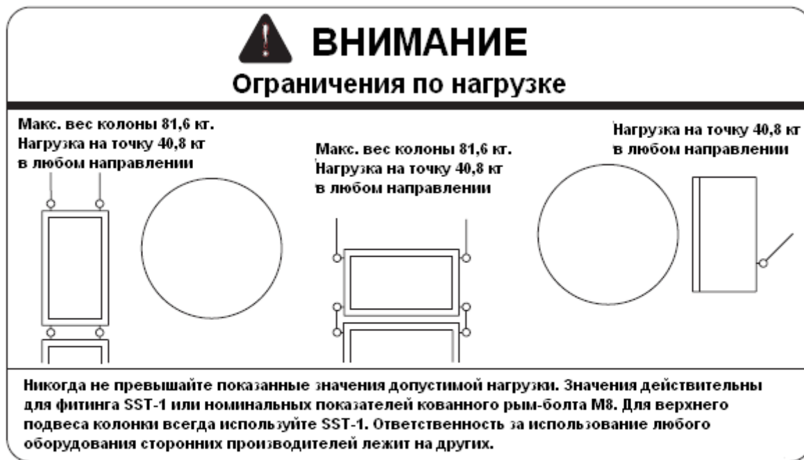
Рисунок 2. Пределы допустимой нагрузки на ZX5
